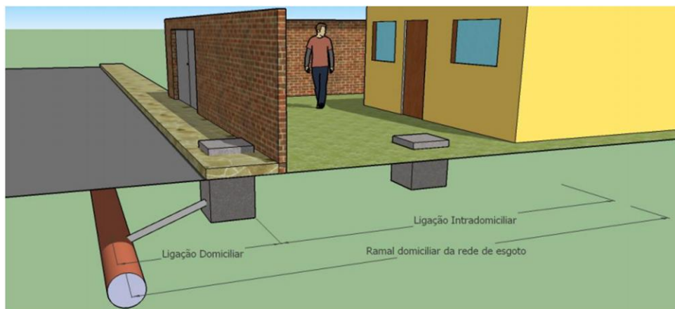
Figura - Esquema da ligação domiciliar de esgoto
