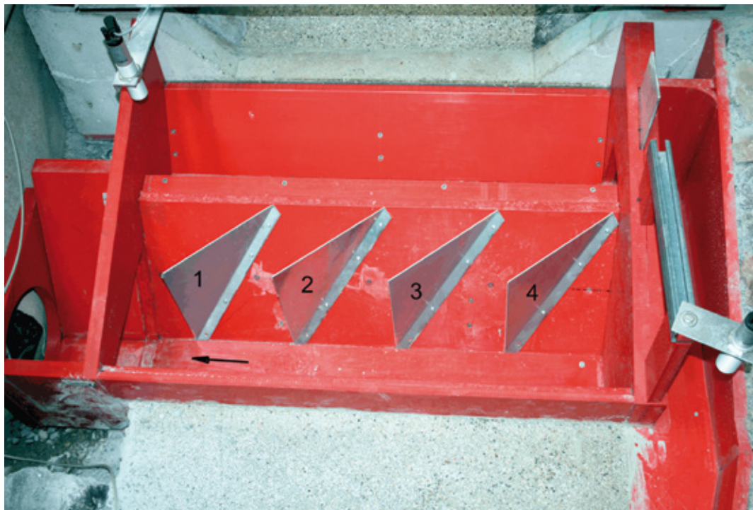
Abb. 7: Leitwände im Wasserabzug zum Entlastungsrohr
