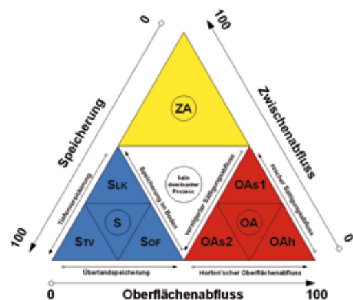
Abb.4: Schema zur Klassifizierung der Abflussprozesse.
