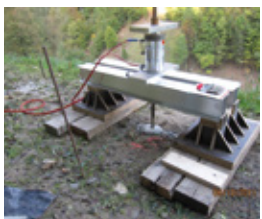
Abb. 1: Zugversuche von Probeankern sollen künftig die Eingangswerte für die Dimensionierung der Systemanker gem. ONR liefern. Mittels Excel-Programm wird die Dimensionierung hierfür erleichtert. (Im Bild: ONR-gerechter Ankerzugversuch mit dem Ankerprüfgerät GBL 2.3.)
