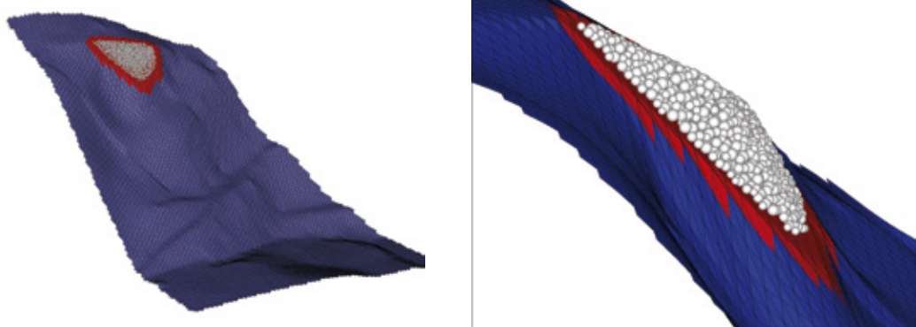
Abb. 9: Modellierung eines Felssturzes mit einem Abbruchvolumen von ca. 2600 m 3 ; Sturzmasse und Geländeoberfläche (9a), Sturzmasse repräsentiert durch eine irreguläre Partikelanordnung (9b) (Preh, 2010).
