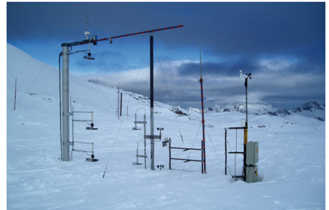
Abb. 9: Messgeräte am Col du Lac Blanc (verschiedene Windanemometer sowie Snow Particle Counter (SPC)).
