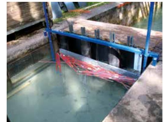
Abb. 6: Lockerer, einlagiger Holzteppich mit kleiner Kompaktheit für \rho_H/\rho_W = 0,8 und \Delta H/H = 5,9\% (links) sowie mehrlagiger Verklauungskörper mit großer Kompaktheit für \rho_H/\rho_W = 0,975 und \Delta H/H = 45,9\% (rechts)
