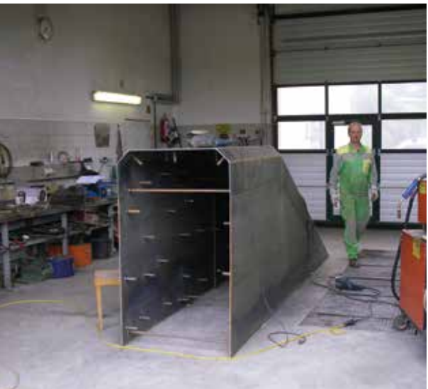
Abb. 2: Vorgefertigte Mittelscheibe einer Filtersperre (Fertigung Bauhof GBL Lungau, Foto WLV)
