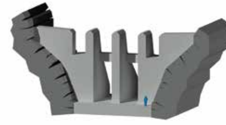
Abb. 5: Modell des Lawinenbrechers im Hopfgartnergraben luftseitig
