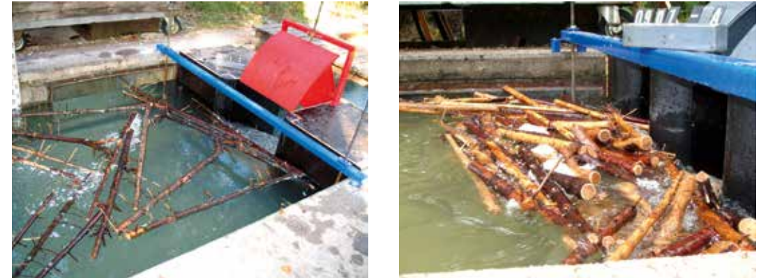
Abb. 3: Lockerer, einlagiger Holzteppich mit kleiner Kompaktheit (links) sowie mehrlagiger Verklausungskörper mit großer Kompaktheit für Fr = 0,35 und \Delta H/H = 15,2\% (rechts)
