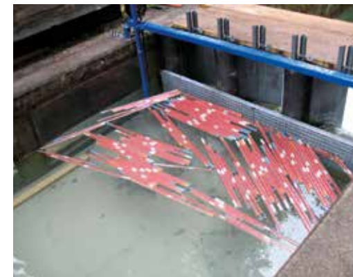
Abb. 6: Lockerer, einlagiger Holzteppich mit kleiner Kompaktheit für \rho_H/\rho_W = 0,8 und \Delta H/H = 5,9\% (links) sowie mehrlagiger Verklauungskörper mit großer Kompaktheit für \rho_H/\rho_W = 0,975 und \Delta H/H = 45,9\% (rechts)
