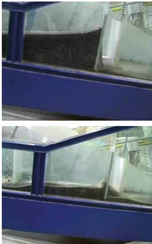
Abb. 4: Laborexperimente zur Ablagerung einer Mure bei einem Kontraktionskoeffizient R = 10 (oben) und R = 2.5 (unten). Wasserdurchfluss und Geschiebedurchfluss sind in beiden Experimenten gleich.
