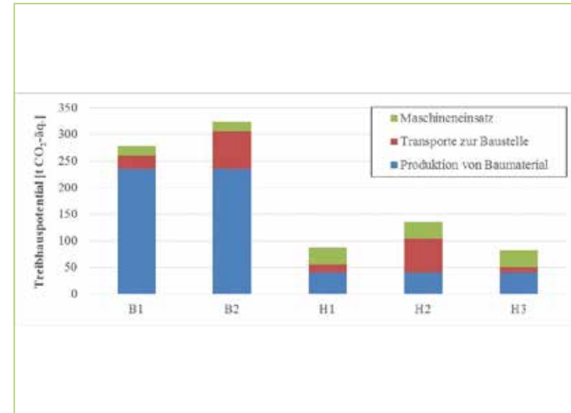
Abb. 16: Treibhauspotential der Errichtungsphase für die tatsächlichen Varianten B1 und H1, sowie die Varianten mit erweiterten Transportdistanzen (B2 und H2) und der Variante H3 mit geringen Transportdistanzen auf Grund der Verwendung von regionalem Holz.
