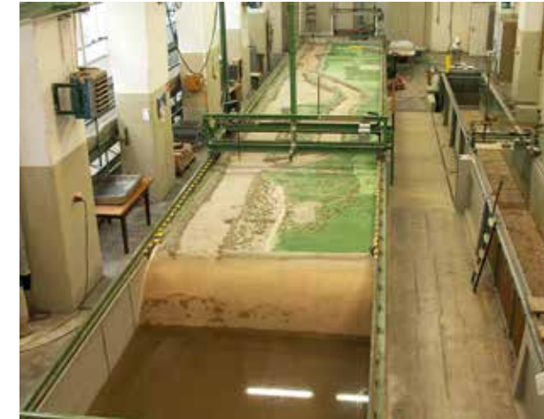
Abb. 6: Versuchsrinnen am IWB: (1) Glasrinne für Schnittmodelle (Breite 1 m) und (2) Versuchsrinne für Vollmodelle (Breite 3 m) (Fotos: IWB 2004)
