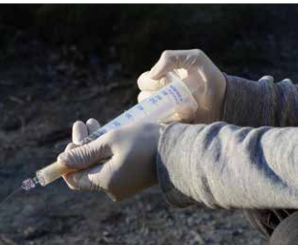
Abb. 1: Filtration von Wasserproben im Gelände manuell (© Traugott) und parallel mittels elektrischer Pumpe (© Thalinger)
