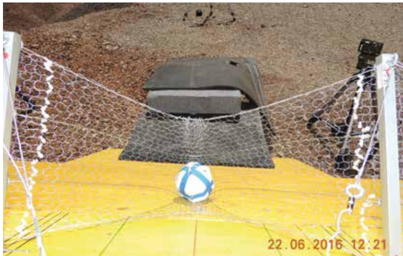
Abb. 7: Impaktmodul nach Systembelastung (oben: i0216_01 (schräg), unten: v0315_01 (vertikal))
