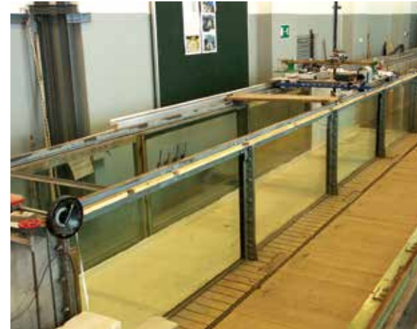
Abb. 6: Versuchsrinnen am IWB: (1) Glasrinne für Schnittmodelle (Breite 1 m) und (2) Versuchsrinne für Vollmodelle (Breite 3 m) (Fotos: IWB 2004)
