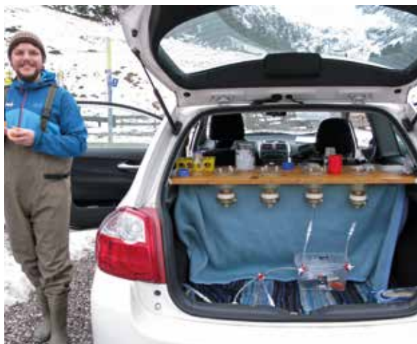
Abb. 1: Filtration von Wasserproben im Gelände manuell (© Traugott) und parallel mittels elektrischer Pumpe (© Thalinger)
