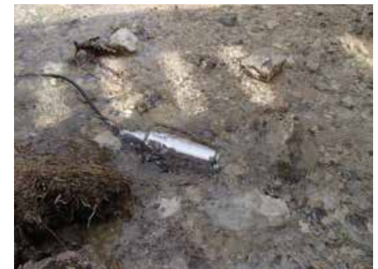
Abb. 2: Messung der Intensität des seitlichen Streulichtes
