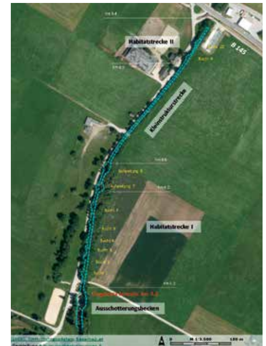
Abb. 5: Der untere Rödschitzbach mit den wichtigsten, im Zuge des BBL-Renaturierungsprojektes hergestellten Strukturen. Basis: Orthofoto WebGIS Stmk., Einmessung per GPS und Zeichnung: H. Haseke
