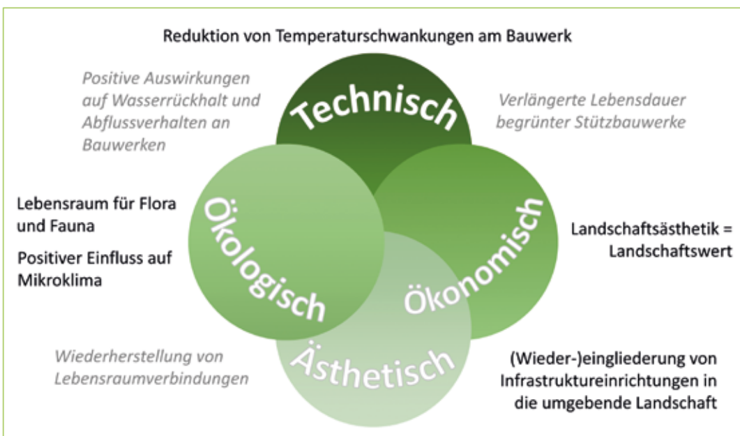
Abb. 2: Wirkungsweisen ingenieurbiologischer Bauwerke am Beispiel ‚Green Wall‘; schwarz: im Projekt belegte Aussagen, grau: Hypothesen, die durch weitere Forschung nachgewiesen werden müssen.
