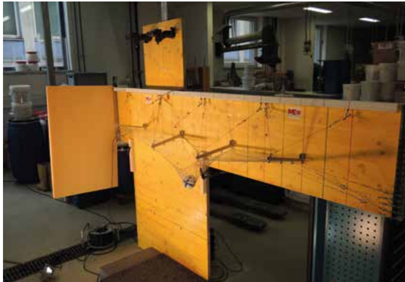
Abb. 2: Versuchsanordnung im Labormaßstab (vertikal 90° vs. schräg 30°)
