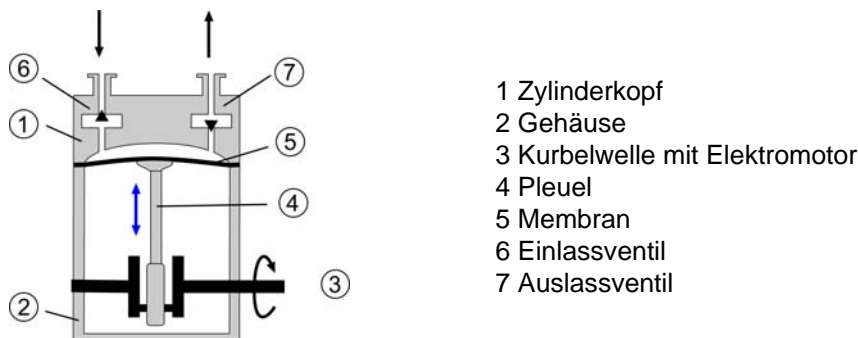
Abb. 4.29: Funktionsweise der Membranpumpe
